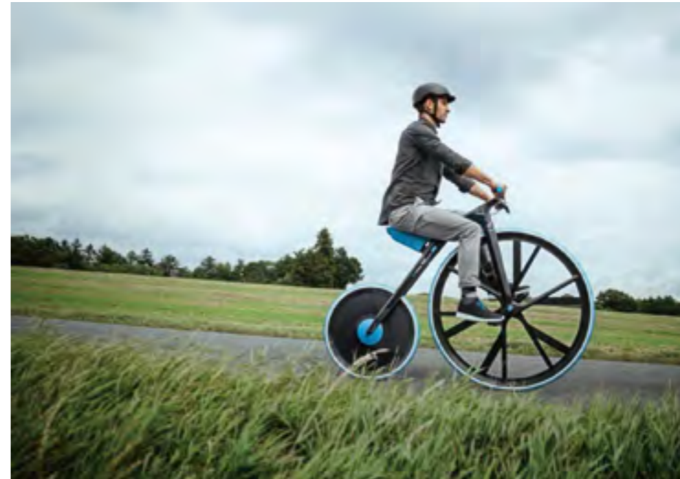
“概念 1865——材料再思考”的电动自行车，由 24 种尖端特性塑料材料制造，最高可减重 60%。
