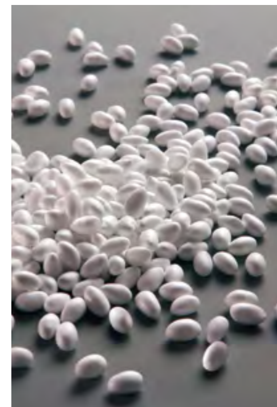
回弹材料：2500 颗 Infinergy 颗粒组成全新跑鞋的中底。
